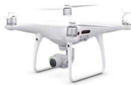
Sensor CMOS de 1" y 20 MP    Tiempo de vuelo 30 min    Detección de obstáculos en cinco direcciones
