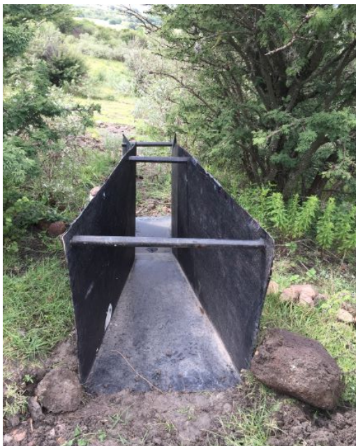
Figura 15. a) Aforador en punto de salida de la unidad de escurrimiento con manejo y obras de ejido Puerto de Nieto. b) Aforador en punto de salida de escurrimiento en la unidad con manejo y obras de ejido Puerto de Nieto.
