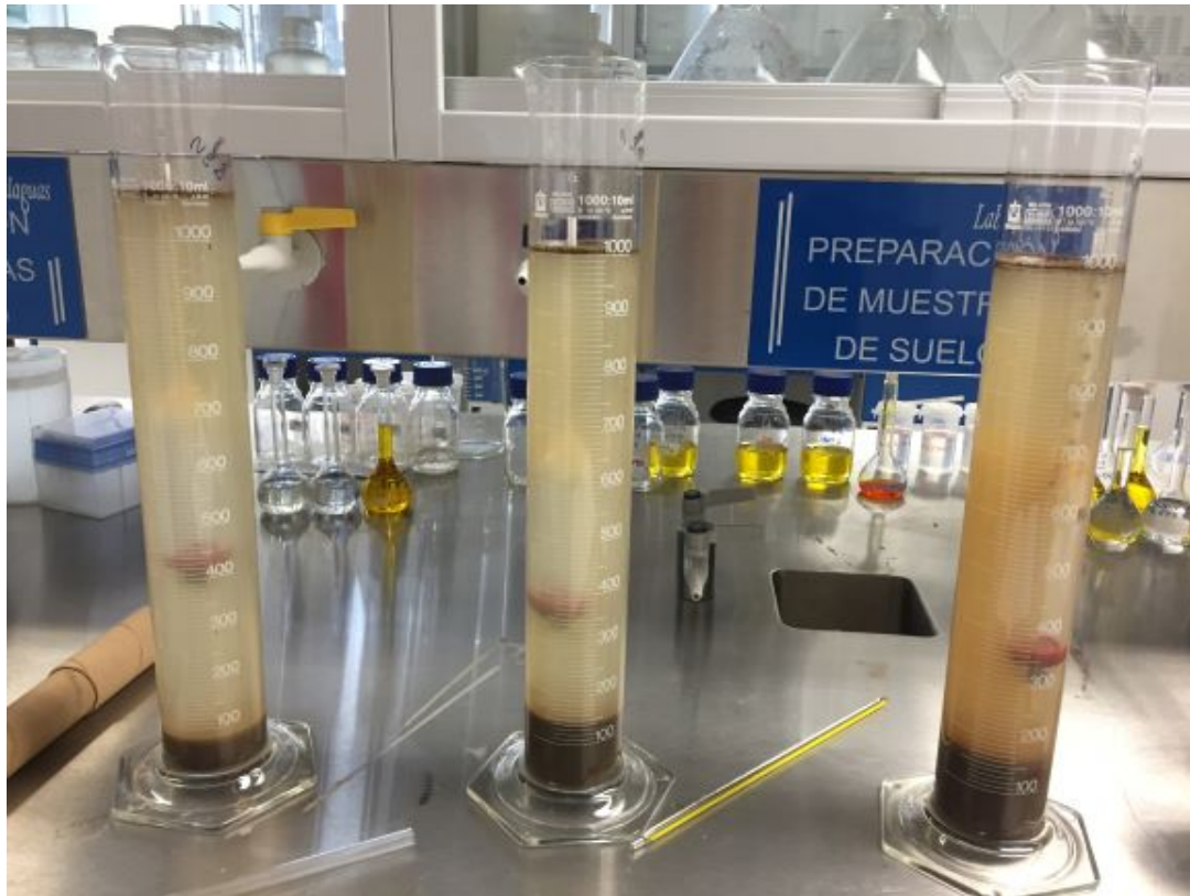
Figura 11. Determinación de la textura del suelo con hidrómetro de Bouyoucos en el laboratorio CALAGUAS-MAGIC)
