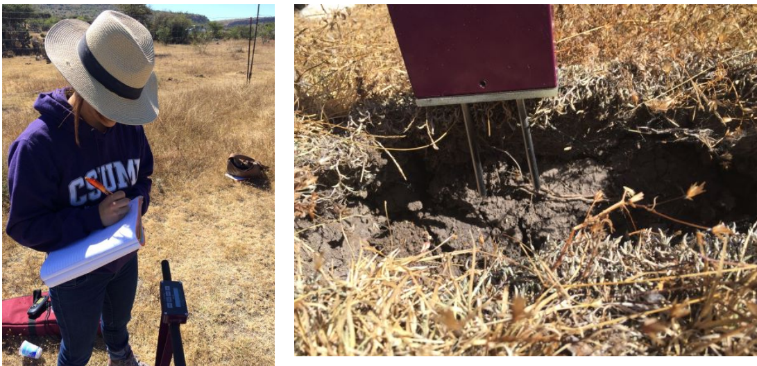
Figura 10. Documentación del muestreo con el medidor de humedad de suelo, en las unidades CONSABIO.
