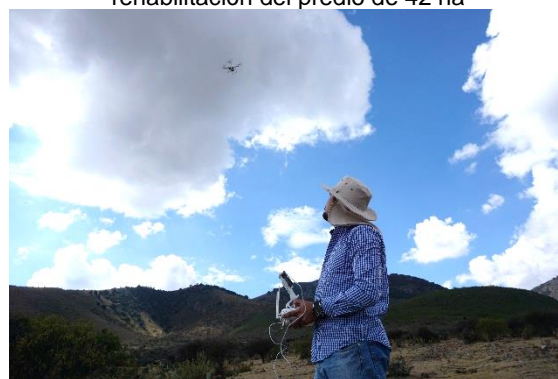
Registros fotogramétricos para elaboración del mapa base y las diferentes capas que forman parte de los productos a entregar del proyecto de rehabilitación de suelos
