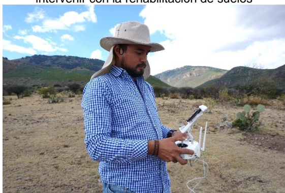
Registros fotogramétricos para elaboración del mapa base y las diferentes capas que forman parte de los productos a entregar del proyecto de rehabilitación de suelos
