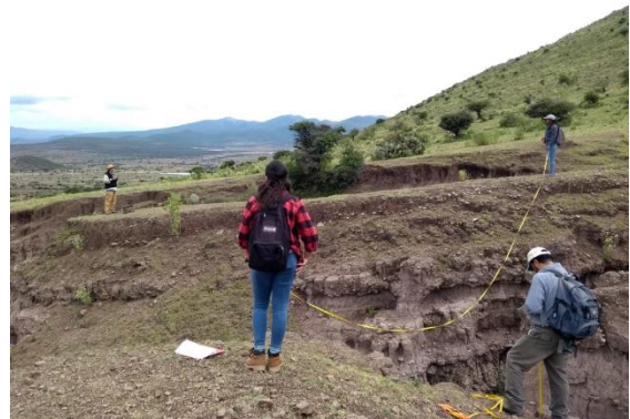
Medición y registro GPS de las cárcavas presentes en el predio.
